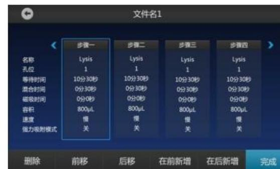
在文件编辑界面点击管理步骤，可对文件内的步骤进行删除、前移、后移、在前新增和在后新增步骤设置。设置完后点击完成回到上一界面。
