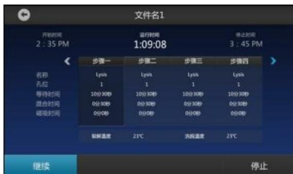
在运行详情界面，下侧左边是暂停图标，右侧为停止图标。点击暂停图标后停止运行，并显示为继续图标，点击继续，运行开始。点击停止图标，该文件运行终止并返回操控主界面。
