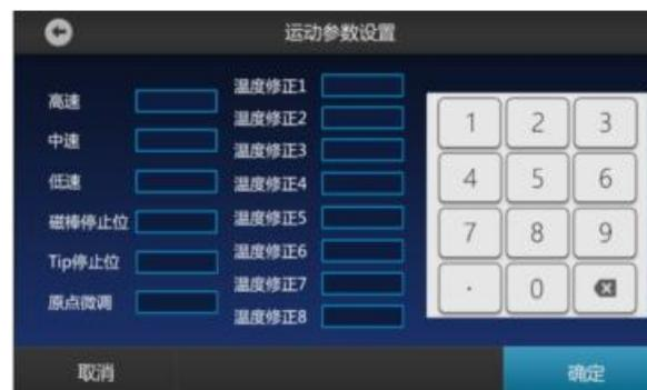
运动参数设置界面包括高速、中速、低速、磁棒停止位、Tip 停止位、原点微调以及温度修正 1-8。相关参数设置完成后，点击确认，系统重置，返回开机界面，待操控主界面显示后，可进行下一步操作。
