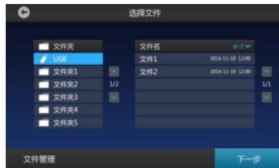
插入 USB 存储设备，显示“选择文件”界面（未插入 USB 时不显示此界面）。点击左侧置顶的文件夹，右侧出现“文件列表”栏，点击所需文件后可进行下一步操作
